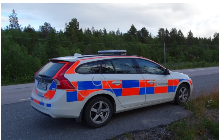
Figur 5.2 Utmärkning med battenburgmönster.
