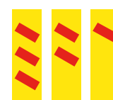
A38-(1-2-3)-V Avstånd till plankorsning Normal=300x1000mm
