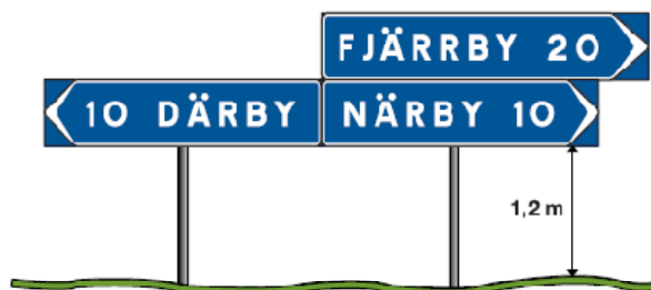
Figur 6.3.3 Vägvisare placeras 1,2 m över körbana. Vägvisare kan även placeras ovanpå varandra.
